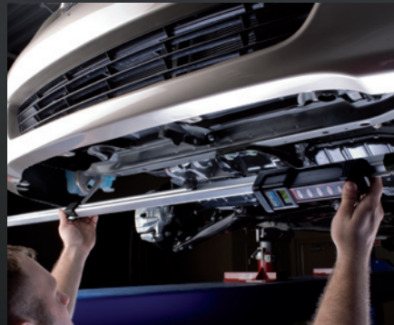
Gövde altı Bilyeli mafsal boyu, radyatör destekleri, traversler, motor beşiği ve kısa putrel dahil olmak üzere gövde altı boyutları ölçer. Baklava şeklindeki bir yamulmayı çabucak kontrol etmek için de idealdir.
