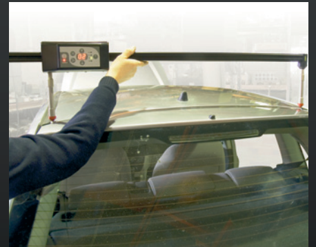
Ön Camlar ve Arka Cam Noktadan noktaya herhangi bir uzunluk, genişlik veya köşegen ölçümü.
